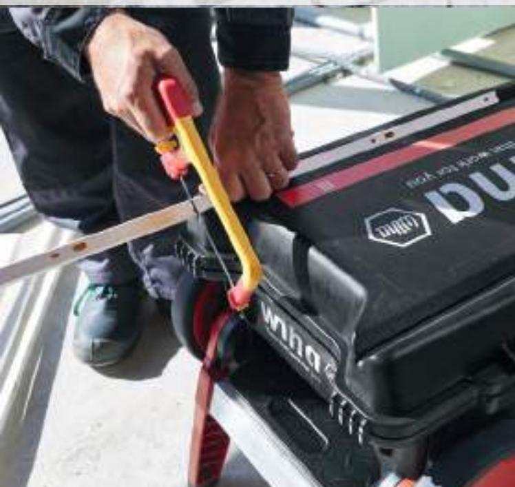
V-formede hakk med skala i koffertlokket
